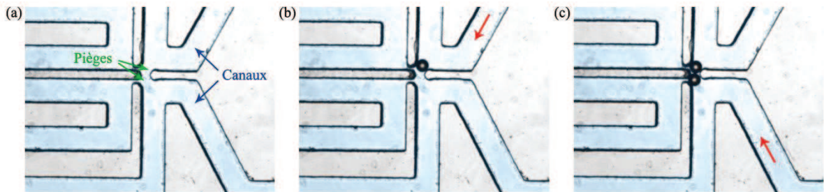
Figure 4.29 – Essais d'appariements de particules de 70\ \mu\text{m} . (a) Photographie effectuée avant l'injection des billes. (b) Une bille est attirée dans un des pièges. (c) Une seconde bille est piégée en face de la première. Les autres billes ne sont alors plus attirées par les pièges et les contournent.
