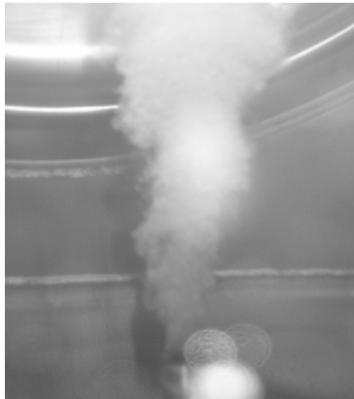
Figure III.23. Formation d'un panache lors de l'injection de la MEC.
