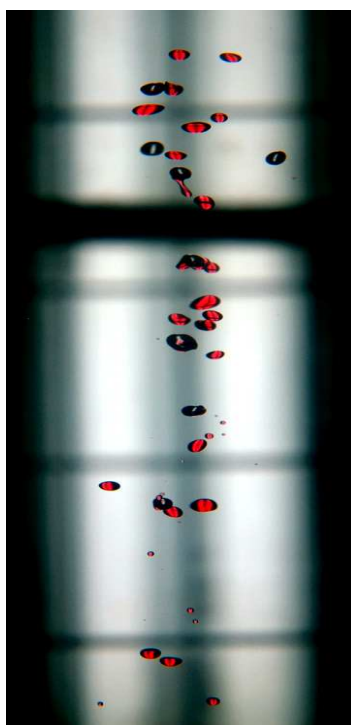
Figure III.22. Injection du DMDS en dessous de la surface d'eau. Les gouttes de DMDS (qui tombent) sont colorées au rouge organol.
