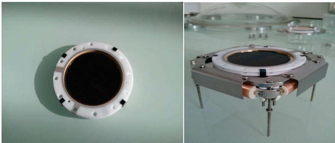
**Figure 5.23: Gauche: les MCP de Hamamatsu dans l'assemblage Roendek. Droite: l'ensemble monté sur la ligne à retard.**
