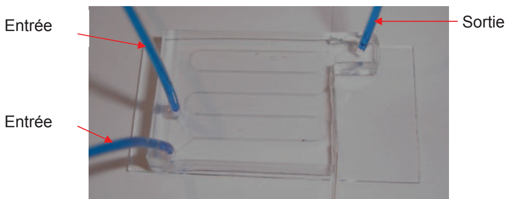
Figure 1 : Principe de la détection des métaux lourds par fluorescence en circuit microfluidique
