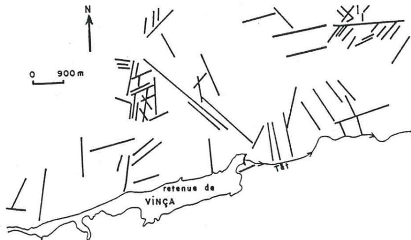
Fig. 3.- Schéma de fracturation du site de Vinça (photointerprétation).
