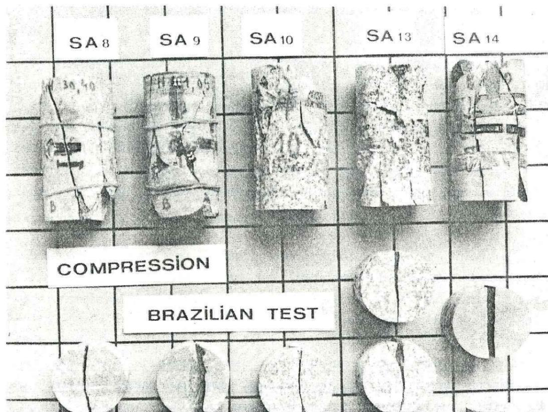
Figure 13. - Eprouvettes de granodiorites d'Aridah (essais de compression et de traction).
