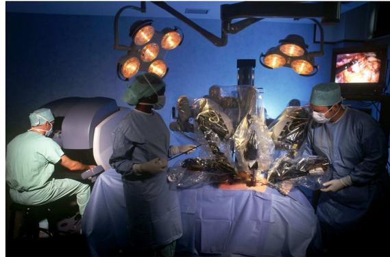
FIGURE 1.8 – Exemple de la configuration de la salle d'opération du robot da Vinci avec un système de téléopération.
