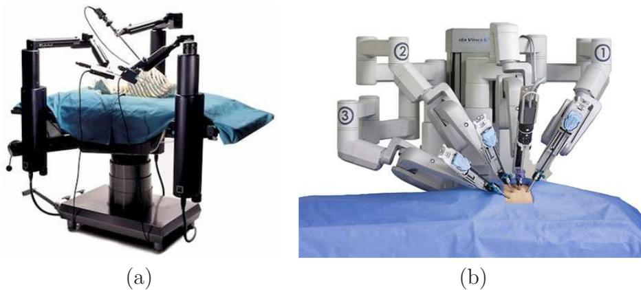
FIGURE 1.7 – Les systèmes de téléopération : (a) Zeus ; (b) da Vinci.
