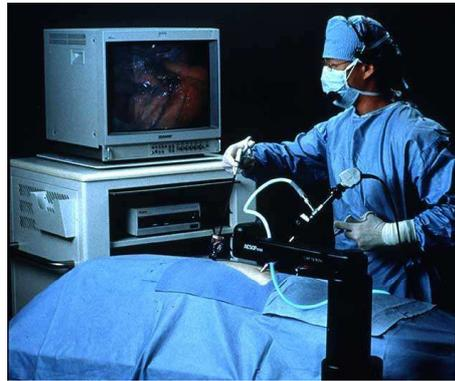
FIGURE 1.6 – Le robot AESOP destiné à manipuler l'endoscope à la place du chirurgien.
