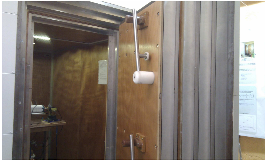
FIGURE A.4.: Chambre blindée amagnétique utilisée lors de la caractérisation des performances en bruit.
