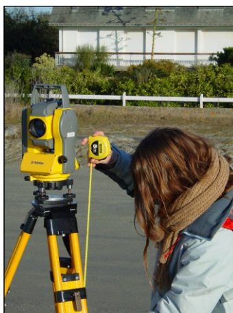
Photo III.1 : Mise en station du théodolite Laser
