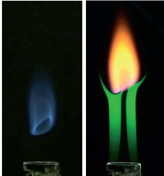
Figure 4 : Comparaison de la flamme dans des conditions d'injection identiques sans et avec encens. Q_{CH_4} = 3,14 \text{ cm}^3/\text{s} Q_{air} = 49,9 \text{ cm}^3/\text{s} Q_{O_2} = 0,885 \text{ cm}^3/\text{s} .
