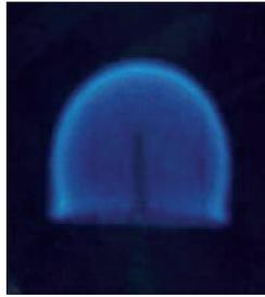
Figure 13 : Flamme de bougie en microgravité.
