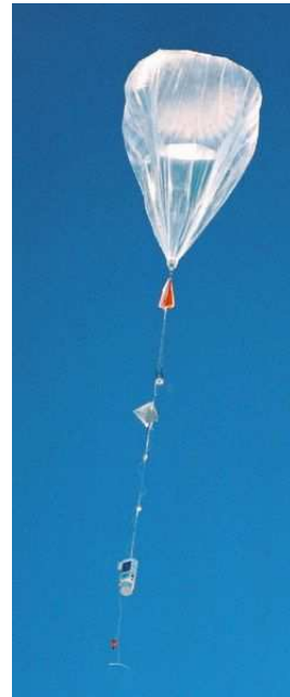
FIGURE 1.2 – Ballon emportant une sonde à ozone. On peut distinguer de haut en bas : le ballon, le parachute (rouge), le réflecteur radar et enfin la nacelle. © SA-IPSL.
