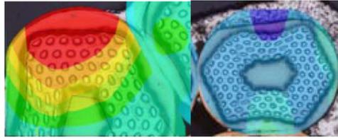
FIGURE 2.19 – Superposition du modèle éléments finis et d’une coupe de câble pour deux brins différents [83].
