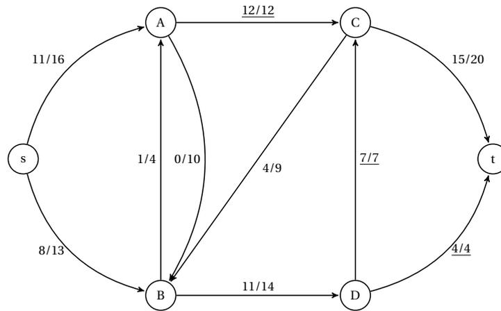
FIG. C.2: Un flot sur le réseau de transport présenté dans la figure C.1. Celui-ci est saturé (cf., arêtes AC, DC et Dt)
