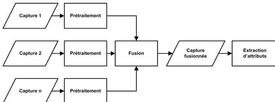
FIG. 4.4: Schéma de fusion au niveau du capteur
