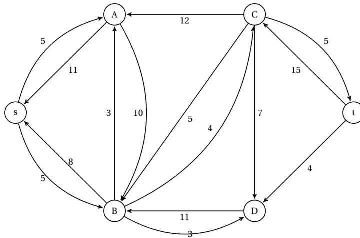
FIG. C.3: Le réseau résiduel sur le réseau de transport présenté dans la figure C.2. Notez la présence de nouveaux arcs (les arcs  $-e$ ) et la modification de la valeur pour les arcs existants (les arcs  $e$ )
