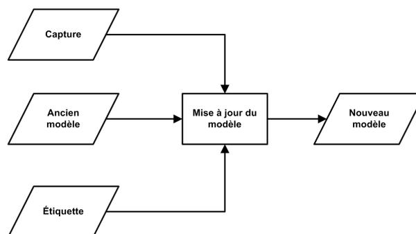
FIG. 5.7: Principe d'une mise à jour supervisée
