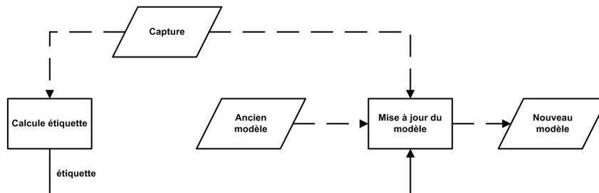
FIG. 5.8: Principe d'une mise à jour semi-supervisée
