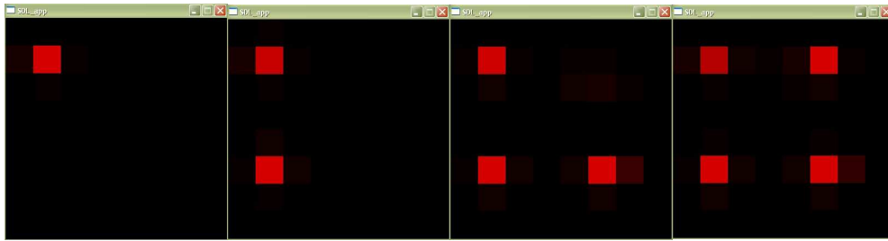
FIGURE 4.18 – Résultat de la mesure en appliquant une pression avec 1 (à gauche), 2, 3 puis 4 (à droite) doigts simultanément.
