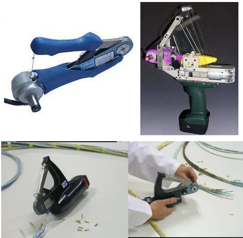
FIGURE 1.5 – « Activateurs » pour pince de sertissage proposés par la société RB3D. La pince de sertissage manuelle d'origine est encastrée dans le mécanisme d'assistance.
