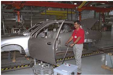
FIGURE 1.11 – Le cobot scooter joue sur l'orientation de ses 3 roues pour créer des guides virtuels quelconques dans le plan. La poignée équipée d'un capteur d'effort permet d'adapter en temps réel le guide virtuel à l'intention de l'opérateur.
