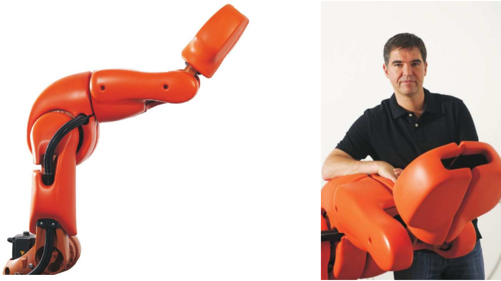
FIGURE 1.13 – Robot Kuka KR 5 ARC HW, recouvert par le kit SafeInteraction proposé par MRK-Systeme.
