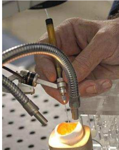
FIGURE 1.10 – Projet SteadyHand, l'opérateur bénéficie de la rigidité du robot et de la précision du capteur d'effort, pour manipuler finement et sans tremblements un outil précis.
