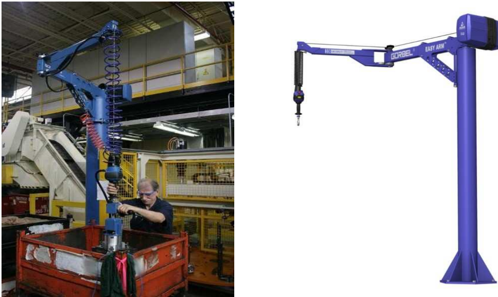
FIGURE 1.8 – Grue de levage EasyArm tm du fabricant Gorbel, permettant une manipulation avec compensation active du poids de la charge (floating mode).
