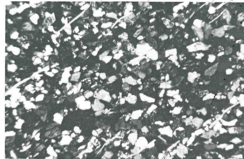
Photographie II.1 - Observation d'une lame mince sous microscope à transmission (lumière polarisée) ; grossissement x30.
