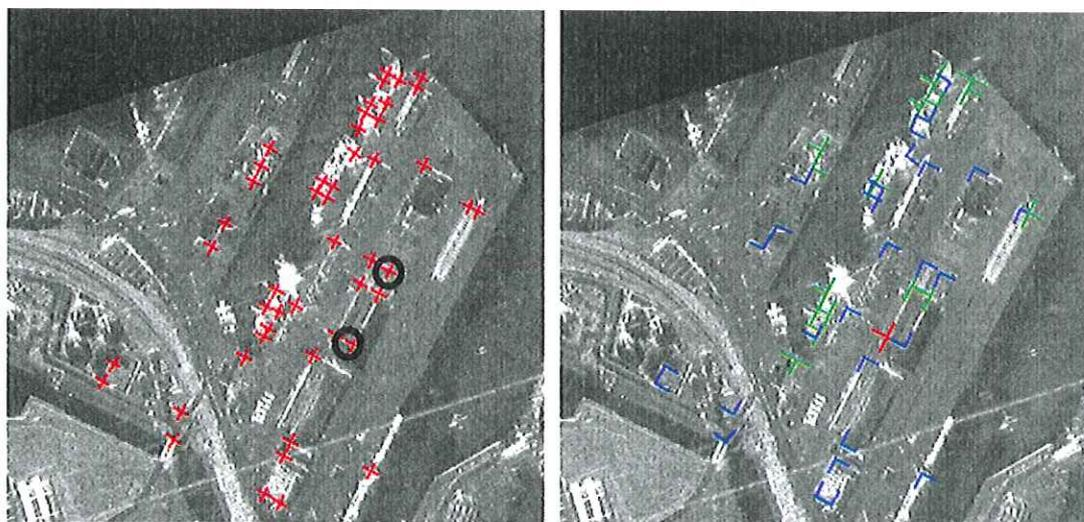
figure 3-33 : TH locale modifiée sur une image en bande X, croix et décision croix/T/coins. Longueur=20. Les cercles noirs indiquent des croix entre l'écho double et l'écho du bord du toit
