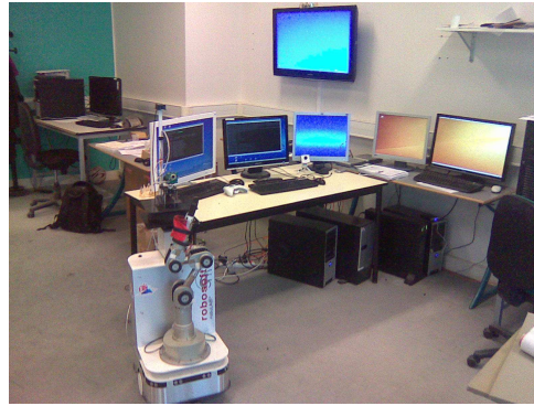
FIG. 6.9: Dispositif expérimental. Le robot est composé d'une plateforme mobile, d'un bras robotique, d'une caméra montée sur deux moteurs en configuration Pan-Tilt et d'une boussole électronique. Le robot embarque un ordinateur ainsi qu'un routeur sans fil WiFi pour communiquer avec les trois machines de calcul distantes.
