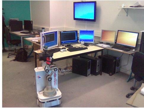
FIG. 6.9: Dispositif expérimental. Le robot est composé d'une plateforme mobile, d'un bras robotique, d'une caméra montée sur deux moteurs en configuration *Pan-Tilt* et d'une boussole électronique. Le robot embarque un ordinateur ainsi qu'un routeur sans fil WiFi pour communiquer avec les trois machines de calcul distantes.
