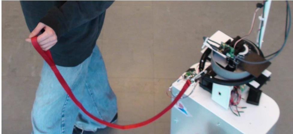
FIG. 9.8: Photo de la première version du cou artificiel monté sur un robot mobile tenu en laisse.
