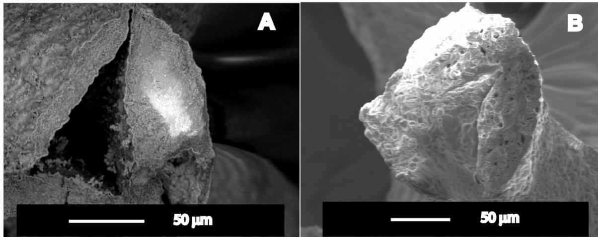
Figure C-71 : clichés MEB montrant le comblement des défauts des poreux par le procédé de double imprégnation.(A) avant et (B) après double imprégnation
