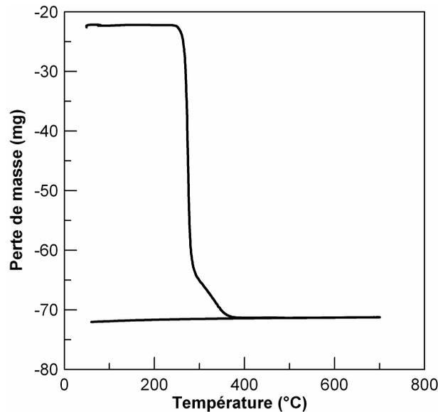
FigureC-76 : ATG billes de PMMA
