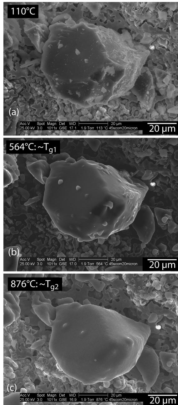
Figure C-10 : Clichés microscopiques à faible grandissement montrant l'évolution d'une particule de bioverre avec la température
