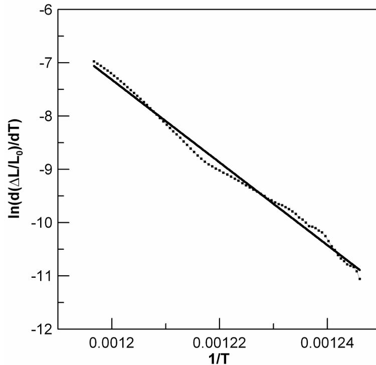
Figure C-34 :  $\ln(d(\Delta L/L_0)/dT)$  en fonction de  $1/T$  sur courbe dilatométrique effectuée à  $5^\circ\text{C}/\text{min}$  entre  $T_{g1}$  et  $T_s$
