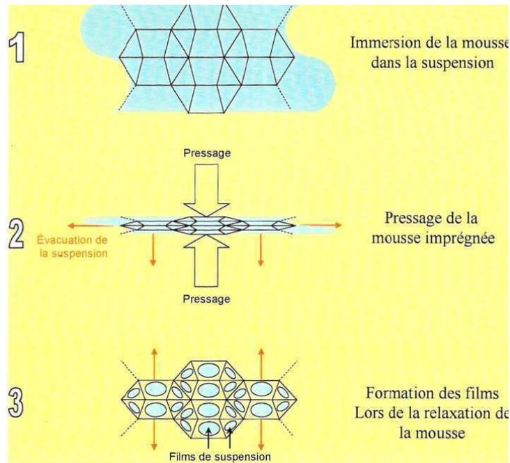
Figure C-6 : Principe de l'imprégnation de mousse
