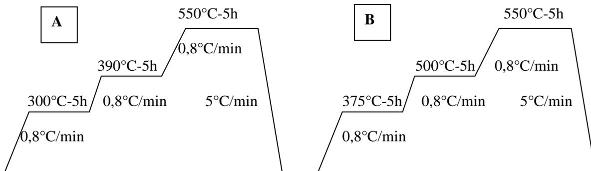
Outre le cycle utilisé, le passage du bioverre 45S5 par sa température de transition vitreuse vers la fin des cycles de déliantage, permet de maintenir une certaine cohésion des poreux. Malgré tout, après déliantage ceux-ci présentent une faible tenue mécanique.
