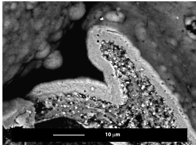
Figure D-4 : Blocs poreux après 3 semaine d'immersion
