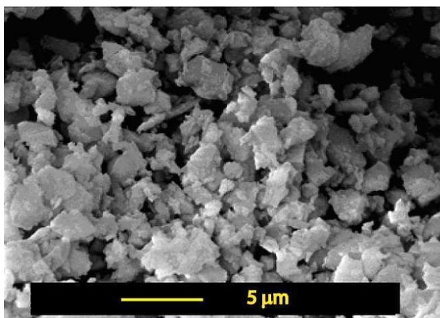
Figure C-7 : cliché de microscopie électronique à balayage d'une poudre brute de bioverre broyée
