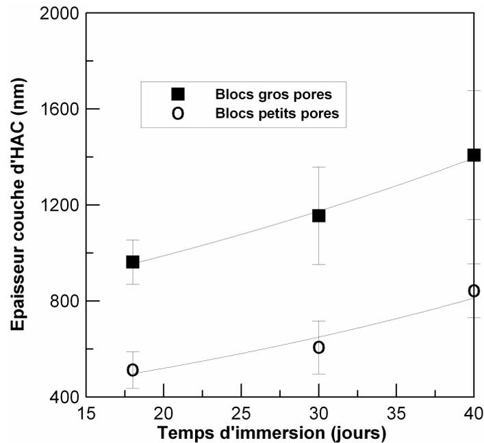
**Figure 7 : Evolution de l'épaisseur de la couche d'HAC à la surface de blocs poreux de bioverre à petit et gros pores prétraités 15 jours dans du SBF et après immersion à différents temps dans du milieu de culture.**
