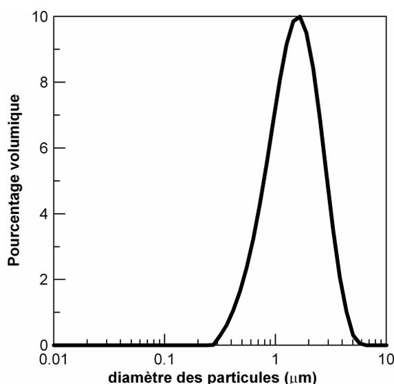
Figure C-6 : Mesure granulométrique de la poudre obtenue après broyage
