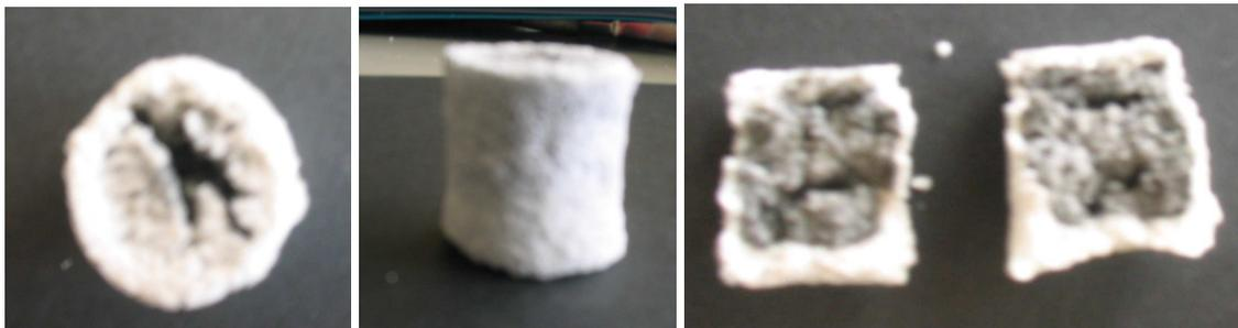
Figure C-74 : poreux obtenus après frittage à 1000°C par combinaison de l'ajout de billes de PMMA et du gel casting.
