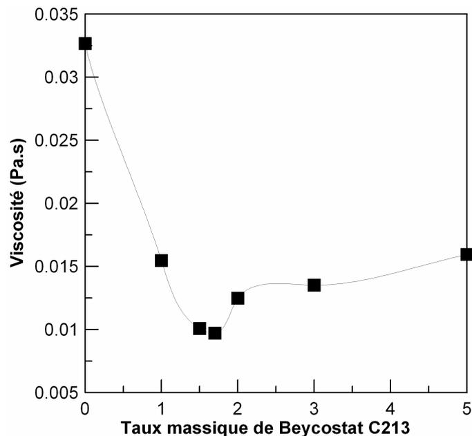
Figure C-53 : Viscosité des suspensions de bioverre dans l'éthanol en fonction du pourcentage massique de dispersant à  $208 \text{ s}^{-1}$
