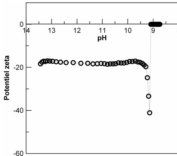
Figure C-55 : Potentiel zeta en fonction du pH obtenue par titrage avec de l'acide nitrique d'une suspension à 35% de matière sèche et avec dispersant
