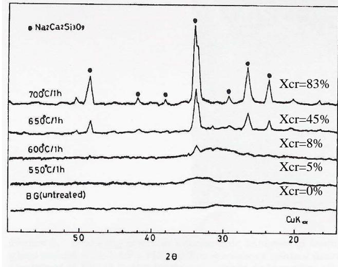
Figure A-11: Spectres de diffraction du bioverre 45S5 traité à 550°C, 600°C, 650°C et 700°C et de la référence non traitée thermiquement. Les spectres font apparaître la formation de  $\text{Na}_2\text{Ca}_2\text{Si}_3\text{O}_9$  avec des taux de cristallinité de 5%, 8%, 45% et 83%.
