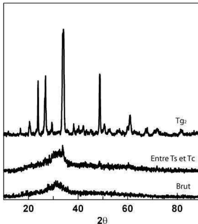
Figure C-33 : Diffractogramme de rayon X réalisés avant frittage, à la fin du premier stade et à  $T_{g2}$
