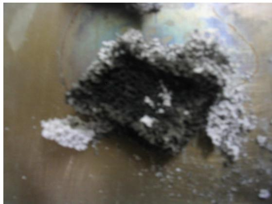
**Figure C-73 : poreux obtenus par combinaison de l'imprégnation de mousse de polyuréthane avec la technique du gel casting**
