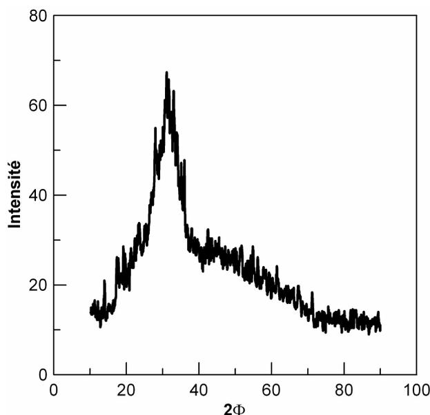
Figure C-5 : Diffractogramme de rayon X du bioverre 45S5 après broyage
