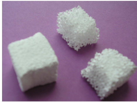
Figure C-63 : poreux obtenus par imprégnation de mousse polyuréthane à petit pores (gauche) et gros pores (à droite)
