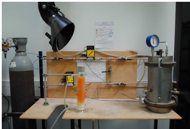
Figure III-3 : Photographie du pilote de carbonatation
