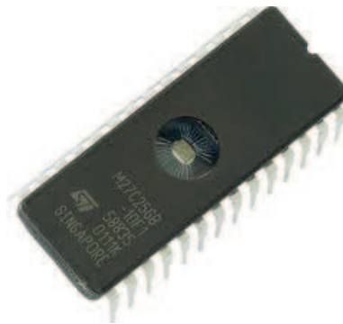
FIG. 1.8 – Cellule mémoire EPROM à fenêtre
