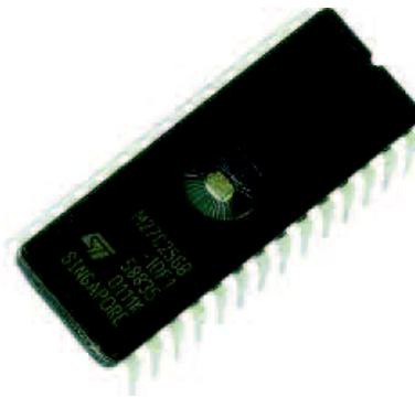
FIG. 1.8 – Cellule mémoire EPROM à fenêtre
