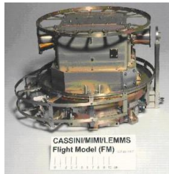
Figure B.III.3 L'instrument MIMI LEMMS. ( http://www.mps.mpg.de/de/projekte/cassini/mimi/index_print.html )
