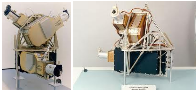
Figure B.III.7 L'instrument RPWS de la sonde Cassini. ( http://mapsview.engin.umich.edu/data_descriptions/RPWS.php ; http://fr.wikipedia.org/wiki/Cassini_(sonde_spatiale) )
