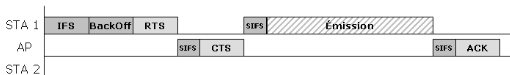
FIGURE 1.10 – Paquet de contrôle RTS/CTS
