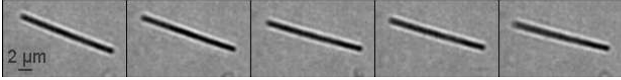
FIGURE 8.2 – Série d’images extraites d’un film d’une aiguille diffusant dans un fluide purement visqueux, un mélange de glycérol et d’eau. L’aiguille est longue de 13.4 \mu\text{m} . Les images successives sont espacées de 2 secondes. Les aiguilles apparaissent sombres sur fond clair, dans la configuration d’enregistrement que nous utilisons. Dans la dernière image l’aiguille sort du plan focal.
