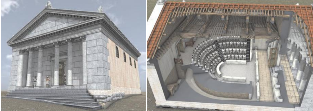
Fig. extraites de la communication : « Restitution 3D, façade vue de trois-quarts au sol » & « Écorché 3D du monument qui montre la proposition d'un plafond dérivé du principe de la charpente macédonienne » ©Éric Follain ».
