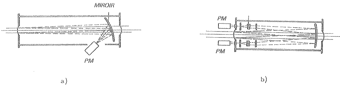
Figure I. 5 : Schéma de principe des compteurs Cerenkov a) compteur à seuil b) CEDAR
