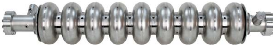
FIGURE 1.2 – Cavité accélératrice supraconductrice de la collaboration TESLA.
