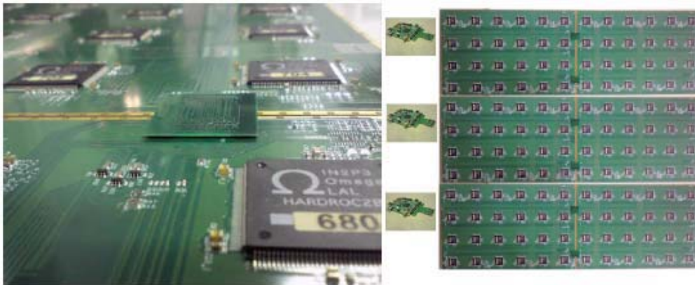
FIGURE 5.40 – (a) : Connexion entre deux circuits de lecture. (b) : Assemblage de 6 circuits de lecture.
