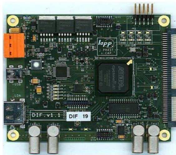
FIGURE 4.7 – Interface détecteur (DIF) développée en collaboration avec le LAPP (in2p3).
