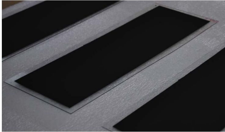
FIGURE 5.19 – Premières série d'électrodes de verre sérigraphiées.
