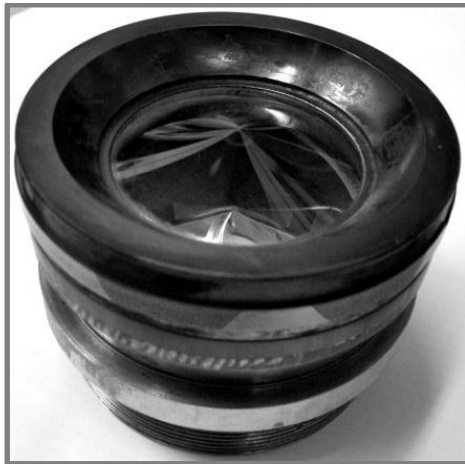
FIG. 2.35 : Photo du piston à accès optiques utilisé pour les expériences en conditions de combustion
