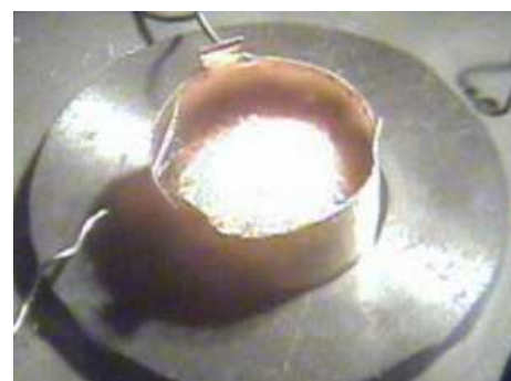
Figure 82 : Embrasement de la poudre d'UC et propagation radiale du front d'ignition
