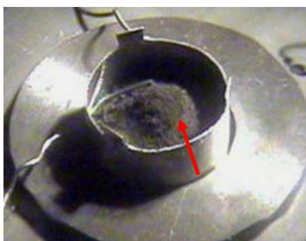
Figure 81 : Noircissement puis rougeoiement de la poudre d'UC
