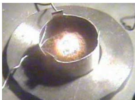
Figure 82 : Embrasement de la poudre d'UC et propagation radiale du front d'ignition
