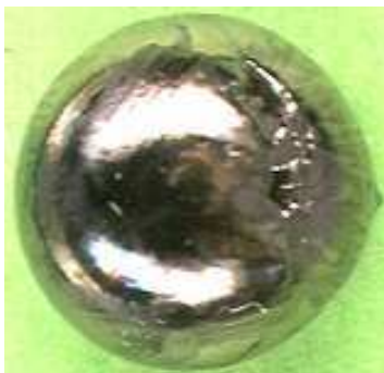
Figure 40 : Photographie d'une bille d'UC (~1g) fraîchement élaborée de 6 mm de diamètre
