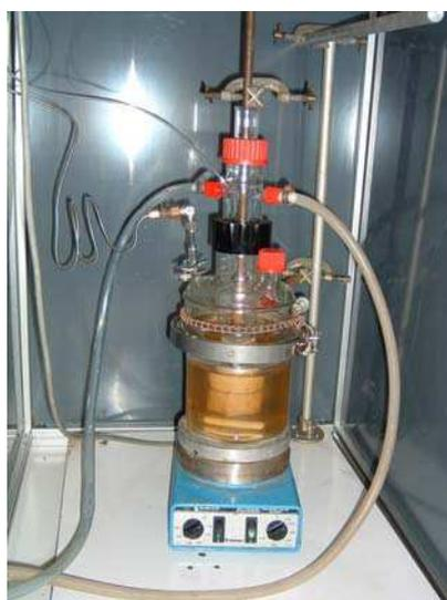
**Figure B-III-1 : montage expérimental pour l'étude du traitement des eaux de cales**
