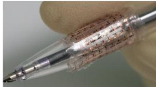
Figure 4.28 : Intégration de capteurs sur support souple par transfert de films
