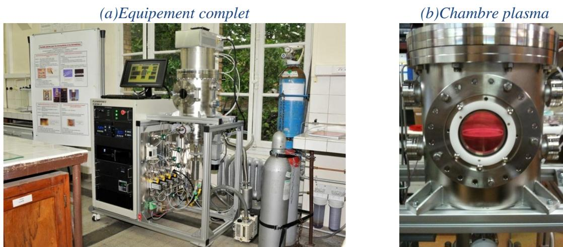
Figure 3.18 : Réacteur plasma FLR-300H, Plasmionique
