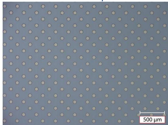
(g) Image acquise au microscope optique d'une matrice de ronds de 100  $\mu\text{m}$  de diamètre
