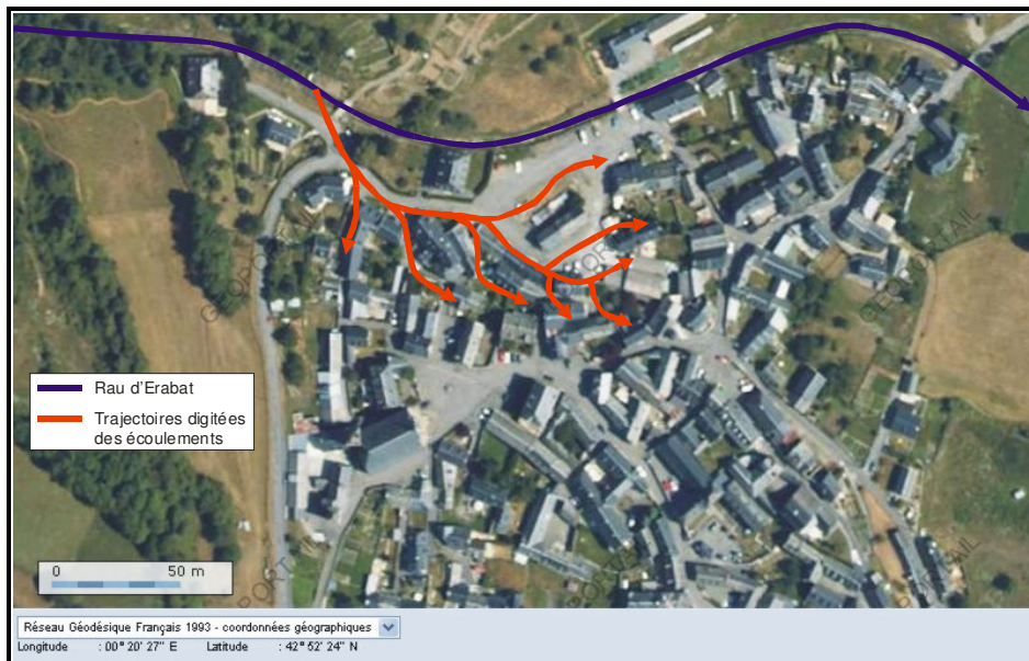
Figure 36 – Rues en arête de poisson et maisons avec pignons-étraves (Ancizan, Hautes-Pyrénées) (J.-M. Antoine, 2011a, à paraître)
