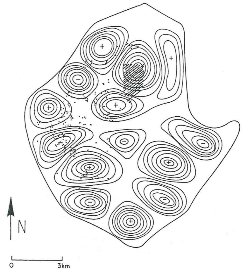
Figure 3.2. Figure 9 de Seligman et al. (1989). Distribution des amplitudes maximales du mouvement résultant de la superposition de sept formes modales calculées pour la partie correspondante au lac de Tenochtitlán montré dans la figure précédente. Les modes de résonance du bassin pour des périodes comprises entre 1,88 et 2,2 s ont été calculés en supposant un demi-espace rigide. Nous lui avons superposé la Figure 5 de Seligman et al. (1989) avec la distribution des dégâts à Mexico pour les séismes de septembre 1985. Chaque point correspond à un bâtiment écroulé ou gravement endommagé. Dans la zone hachurée, un certain nombre de structures entre un et deux étages ont subi des dégâts importants.
