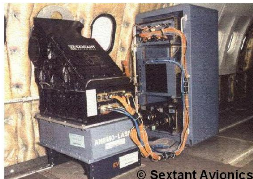
figure 1-8 : Système trois axes ALEV3 installé dans un Airbus A340 utilisé pour l'étalonnage du système anémo-barométrique de l'avion.
