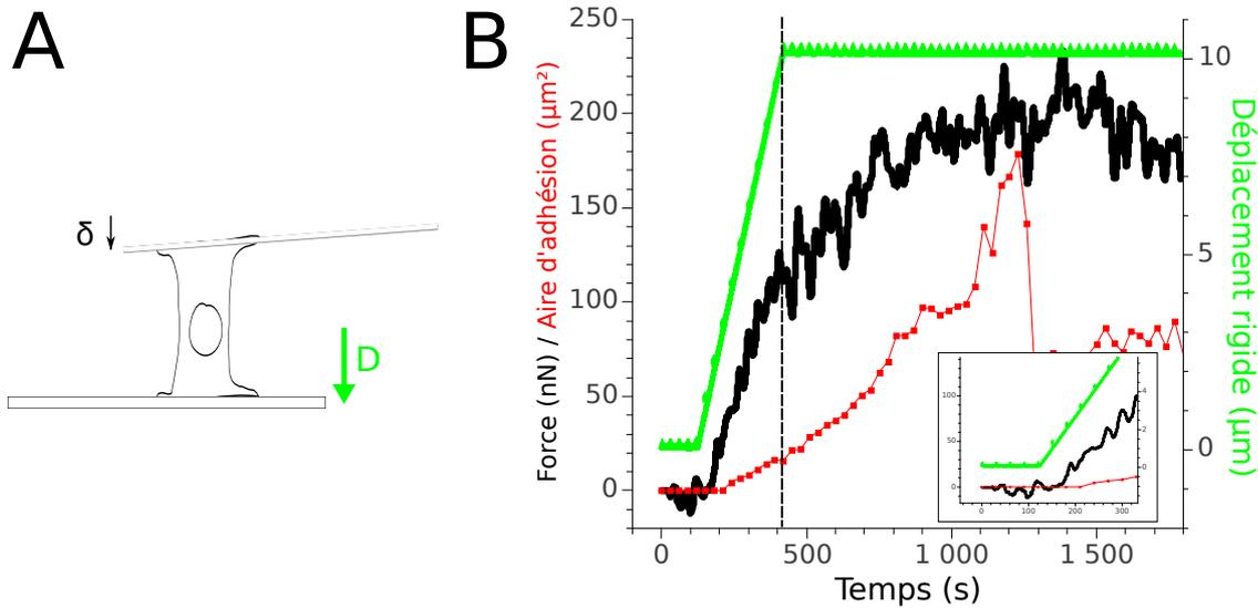
FIGURE 3.21 – A- Principe d'une expérience d'étirement et mesure de force simultanés. B- Graphe montrant la force et l'aire d'adhésion en fonction du temps pendant l'application d'une rampe sur la plaque rigide. En insert, zoom sur les premiers instants de l'expérience.
