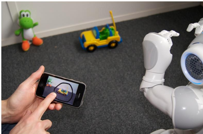
FIGURE 6.3 – L'interface iPhone avec le flux vidéo permettant aux utilisateurs de surveiller ce que voit le robot. Les utilisateurs peuvent dessiner des « trajectoires » directement sur l'écran tactile de l'appareil interprétées comme des commandes.
