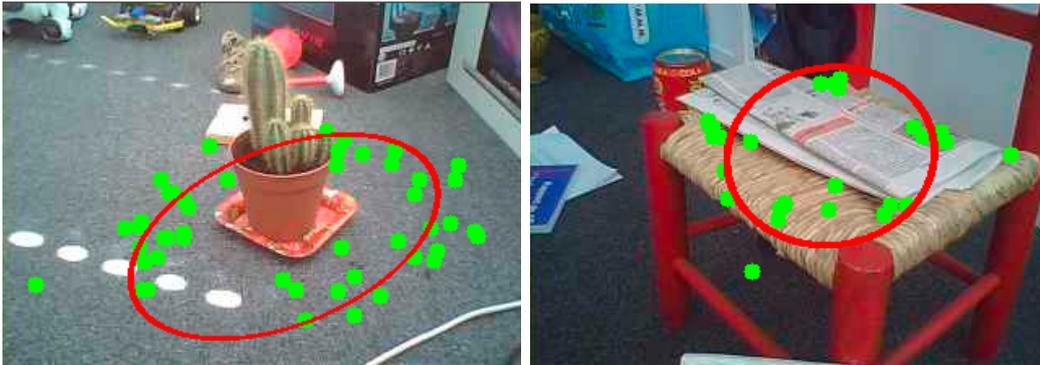
FIGURE 6.9 – Encercler avec le pointeur laser entraîne des problèmes de projection des points détectés sur le plan de la caméra du robot qui peut couper les objets.
