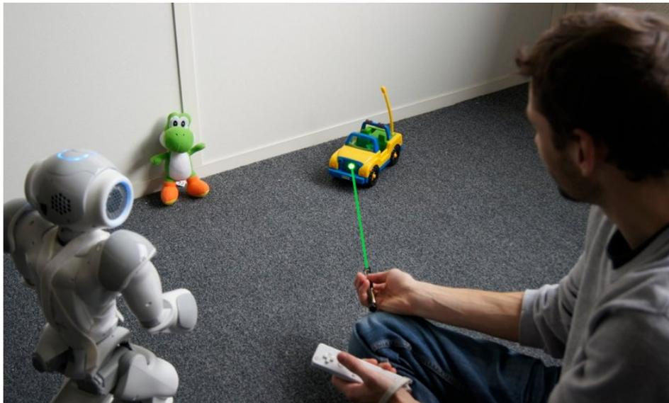
FIGURE 6.7 – Les utilisateurs peuvent déplacer le robot à l'aide de la Wiimote. Ils peuvent aussi attirer l'attention du robot vers un objet en le désignant avec le pointeur laser.
