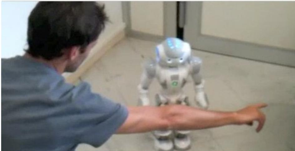
FIGURE 6.11 – Avec ce mode d’interaction, le robot est guidé grâce aux gestes de la main et du bras faits par les utilisateurs. Afin d’avoir une reconnaissance robuste nous avons utilisé un protocole de type WoZ où un humain contrôlait le robot en fonction des gestes reconnus mais il ne pouvait percevoir l’interaction qu’à travers la caméra du robot.
