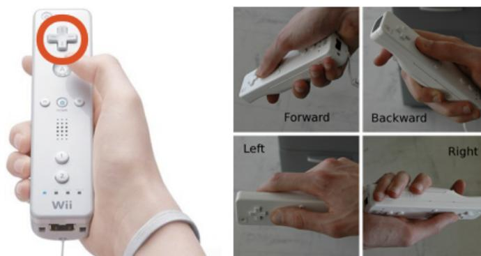
FIGURE 6.6 – Les utilisateurs peuvent demander au robot de se déplacer (marcher avant/arrière et tourner sur lui-même) à l'aide de la croix directionnelle visible sur l'image de gauche. Ils peuvent aussi lui orienter la tête en inclinant le contrôleur Wiimote comme sur l'image de droite.
