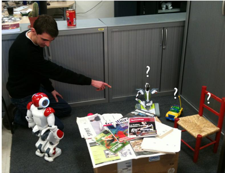
FIGURE 3.2 – Pour permettre à des utilisateurs de désigner un objet particulier dans un environnement complexe, il est nécessaire de fournir un mécanisme de pointage robuste et précis, afin d'éviter que l'interaction soit contraignante et/ou qu'elle entraîne la collecte de mauvais exemples d'apprentissage.
