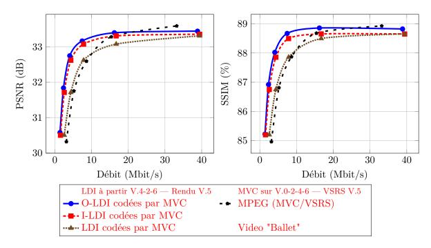
Figure 14: Comparaison débit-distorsion sur la vidéo "Ballet" (MSR), entre les formats LDI, I-LDI, O-LDI, et MVD, tous codés par MVC.
