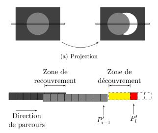
(b) Détails d'une ligne de pixels pour une projection rectifiée.
