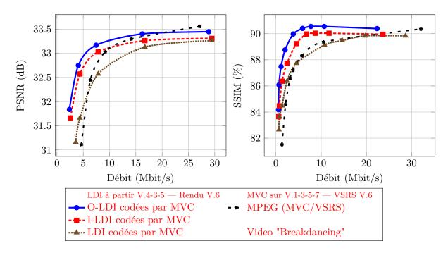
Figure 15: Comparaison débit-distorsion sur la vidéo "Breakdancing" (MSR), entre les formats LDI, I-LDI, O-LDI, et MVD, tous codés par MVC.
