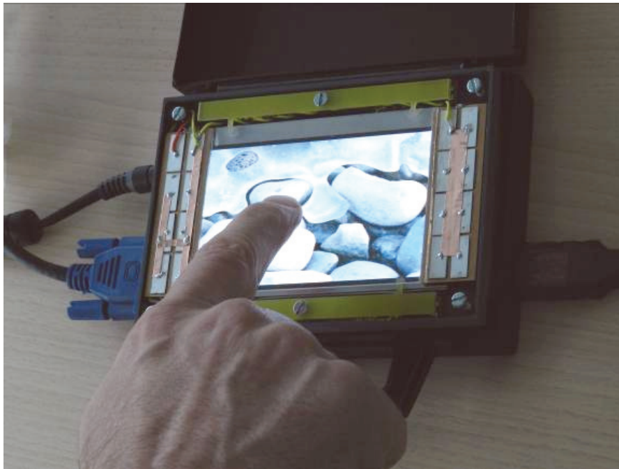
FIGURE 3.9: Version transparente de STIMTAC. Les céramiques piézo-électriques placées de chaque côté de la surface sont faciles à distinguer.
