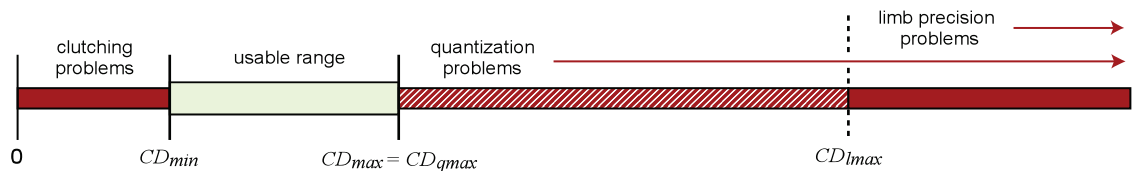
FIGURE 2.4: Représentation de la plage de gain utilisable, dans le cas des fonctions de gain constantes.
