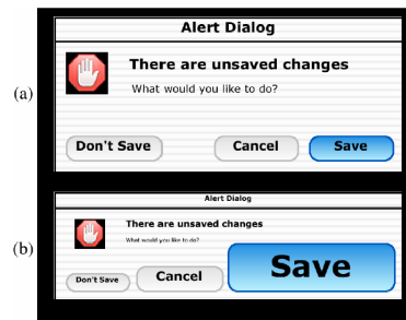
FIGURE 1.28 – (Nouvelle conception pour les boutons) : (a) version visuelle inchangée. (b) version dans l'espace moteur.
