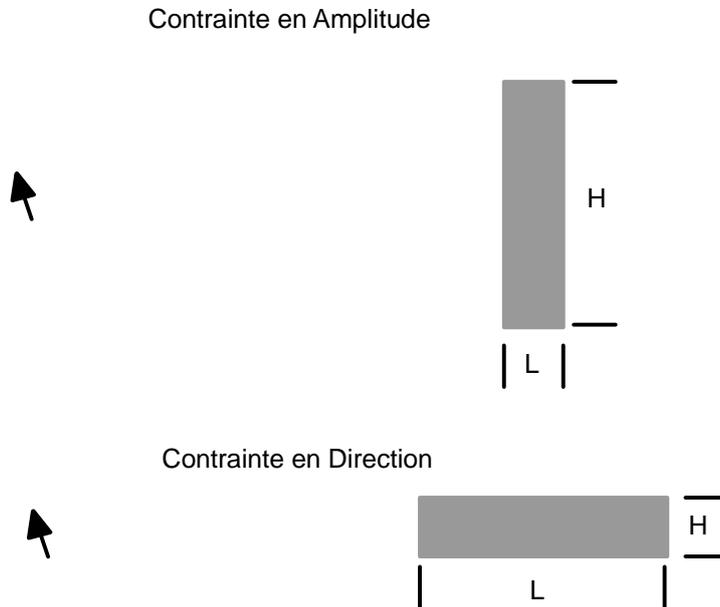
FIGURE 1.11 – Contraintes sur la tâche de pointage. En haut, une contrainte en amplitude, ou contrainte d'arrêt. En bas, une contrainte en direction, ou *steering constraint*.
