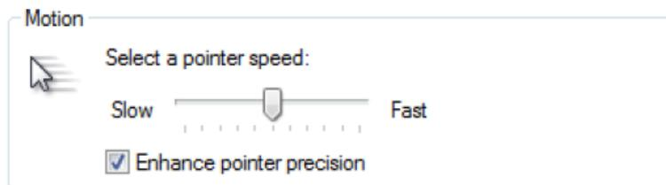
FIGURE 1.13 – Exemple de l'ajustement de la *vitesse* de la souris sous Windows XP (en ajustant cette vitesse, l'utilisateur change en pratique le gain).
