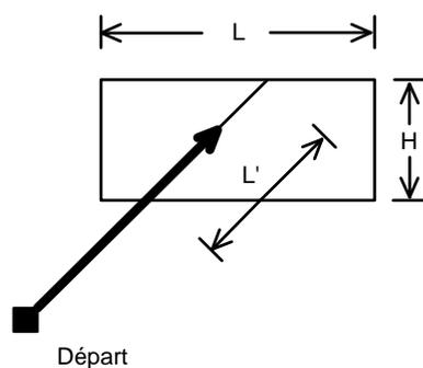
FIGURE 1.12 – Détermination de la largeur effective d'une cible.
