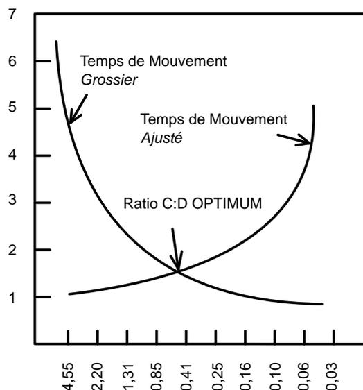
FIGURE 1.14 – ratio CD optimal pour les phases ballistiques et correctives
