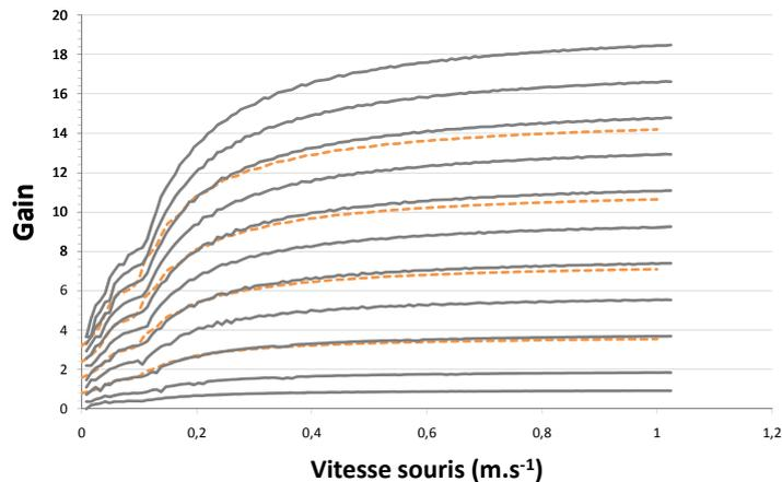
FIGURE 2.12 – Courbes d'accélération Windows XP (en gris) comparées aux courbes trouvées par Casiez ([CVBC08] - en orange pointillé)
