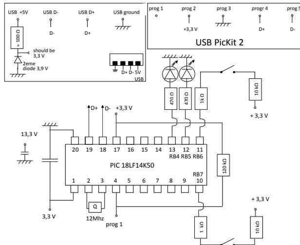
FIGURE 2.6 – Schéma électrique du dispositif d'acquisition.
