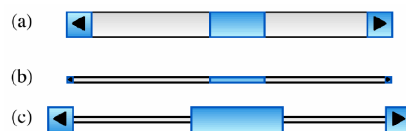
FIGURE 1.26 – ( Nouvelle conception pour les barres de défilement ) : (a) version originale. (b) nouvelle version : espace visuel et (c) espace moteur.
