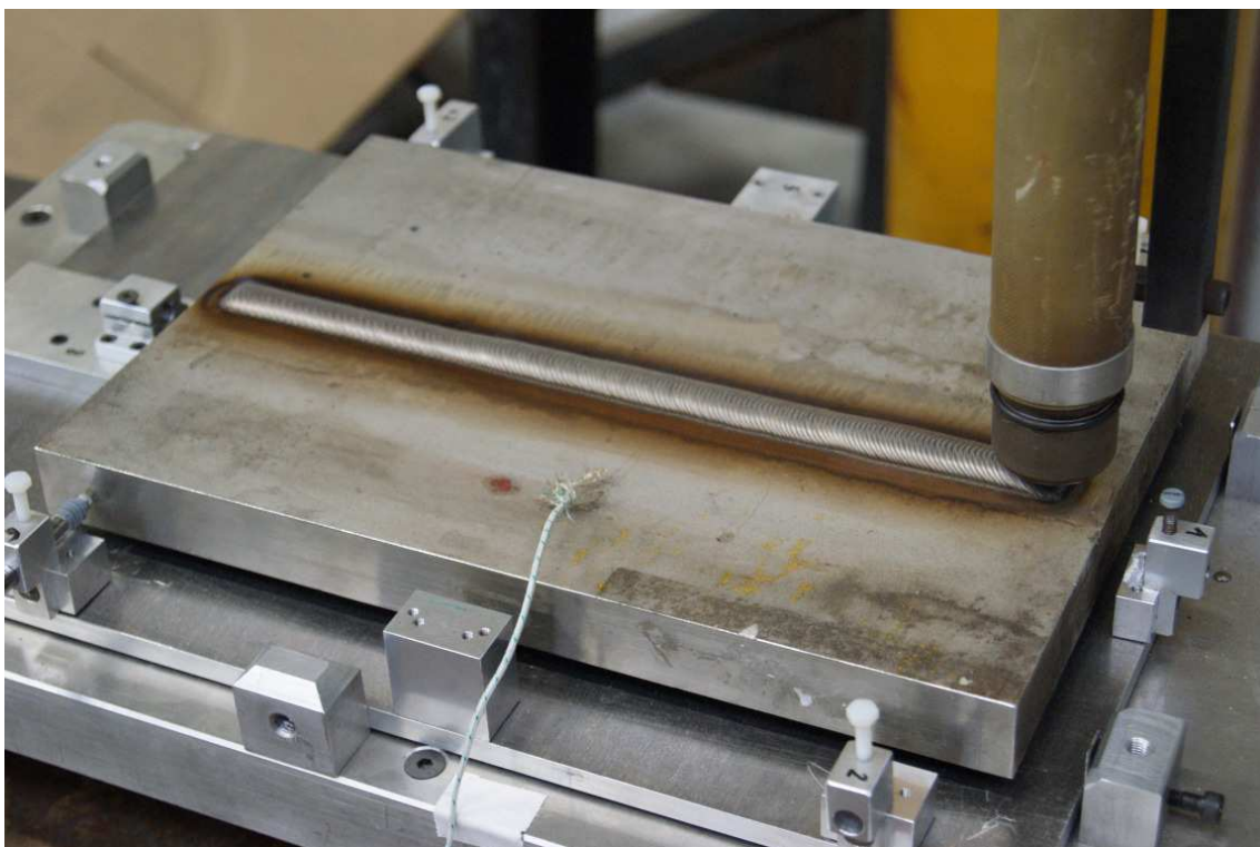
FIGURE 3.3: Cordon rectiligne monopasse sur plaque droite (cas RECT 1).
