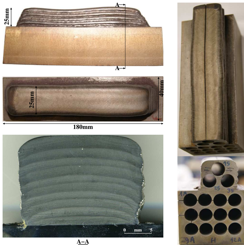
FIGURE 2.1: Découpe par électroérosion d'éprouvettes dans un coupon de Norem02 déposé par soudage PTA.
