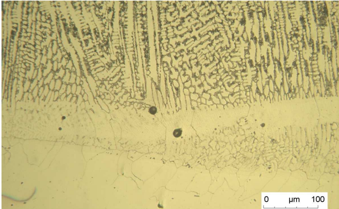
FIGURE 1.4: Macrographie de l'interface entre le métal d'apport et métal de base.
