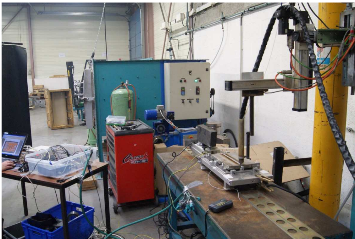
FIGURE 3.2: Dispositif de soudage PTA
