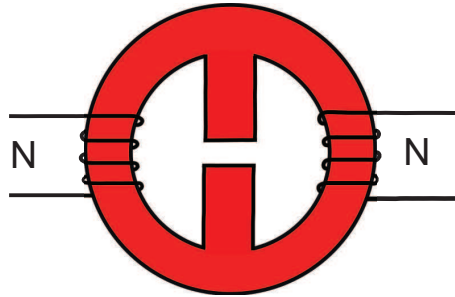
FIGURE II.1 – Topologie basée sur la dissymétrie des trajet de flux
