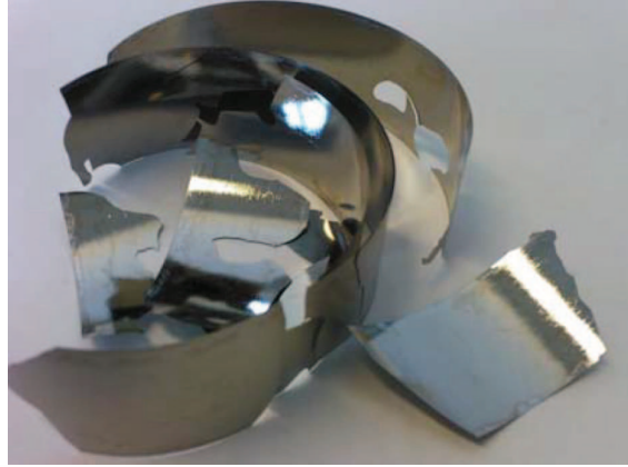
FIGURE II.6 – Fragilité de ruban d’alliage nanocristallin
