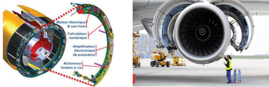
FIGURE 1.12 – Schéma de fonctionnement de l'ETRAS et photo de l'ETRAS en situation sur un A380 [his11].
