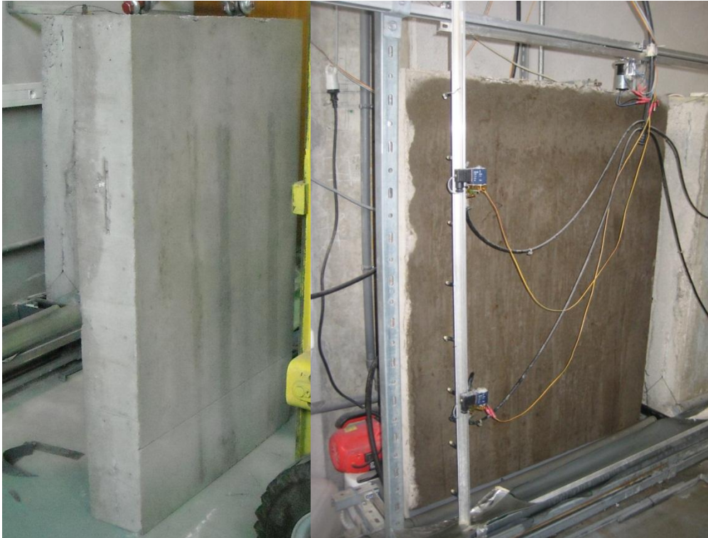
Figure 6.22 Photo du mur pilote et système de lixiviation.
