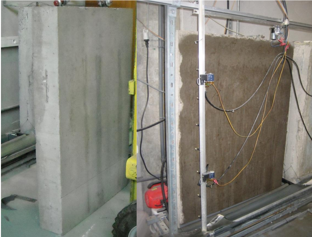
Figure 6.22 Photo du mur pilote et système de lixiviation.
