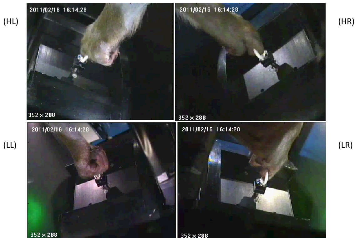
Figure V-6. Jeu de captures d'image pour l'objet « Petit Anneau ». Les lignes de vues de caméras sont centrées au mieux sur l'objet et leur focus est réglé de manière à distinguer la main entière lors de la saisie. HL : caméra placée à l'angle supérieur gauche ; HR : caméra à l'angle supérieur droit ; LL : caméra à l'angle inférieur gauche ; LR : caméra à l'angle inférieur droit.
